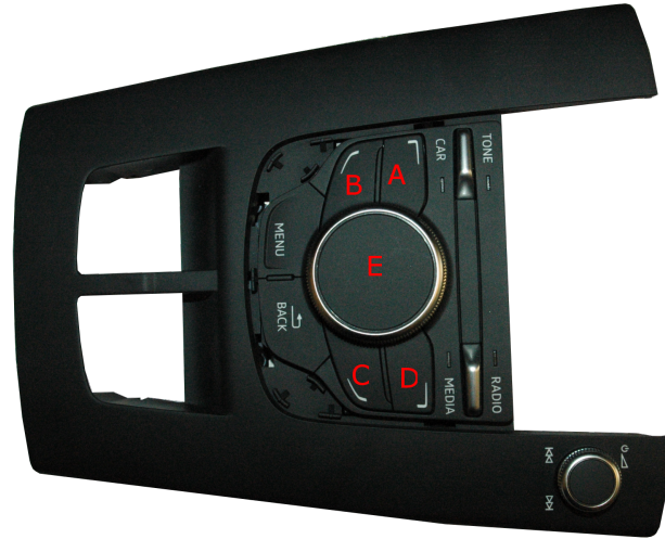
Abbildung 3.5: Audi MMI mit Kurzhubtasten
