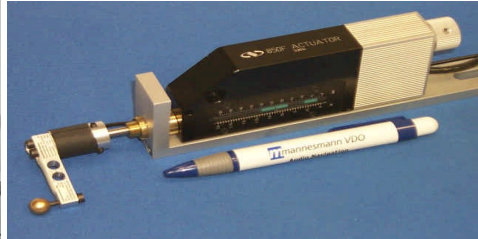
Abbildung 3.10: Kraft-Weg-Messung mit Motor 2 [2]
